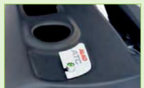
3. La diode sur la commande de freinage clignote (témoin lumineux vert). Le système est prêt à fonctionner.
